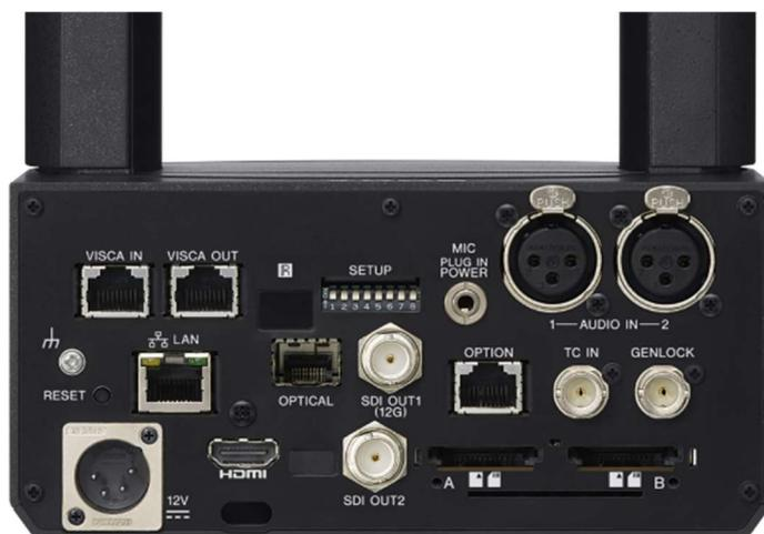
BRC-AM7 具有雙記憶體插槽，均與 CFexpress Type A 和 SDXC 儲存卡相容。插槽 A 和插槽 B 接受 CFexpress Type A 和 UHS II/UHS I SDXC 儲存卡，用於高速存儲和檢索大量數據。雙記憶體插槽還允許同時錄製、接力錄製和代理錄製。
